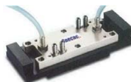
Platine, mode dynamique, thermostatable par liquide
