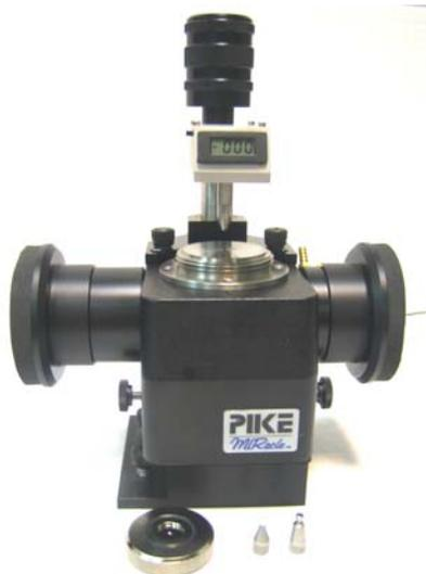
Le Miracle simple réflexion est un système alliant polyvalence et rapidité d'analyse. De part son optique simple à deux miroirs de renvois il possède une transmission élevée.
