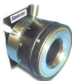
La cellule à parcours optique variable permet d'ajuster le trajet optique en fonction de l'absorption de l'échantillon. Les fenêtres ne tournent pas avec le corps de la cellule, ce qui maintient le parallélisme quelque soit le parcours optique.
