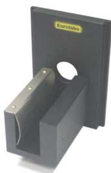
Ce type de support, équipé d'une glissière 3''x2'' et disponible aussi bien pour les cuves parallélépipédiques que pour les cuves cylindriques, permet de mettre en place une cuve ayant un trajet optique jusqu'à 100mm.
