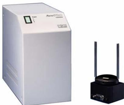
Le 'Rotat-IR' est un dispositif rotatif automatisé qui permet de sélectionner un angle précis de mesure ou de réaliser une programmation. Le logiciel associé qui est écrit en Visual Basic permet d'intégrer des séquences complexes ou encore de stocker des méthodes préétablies.
