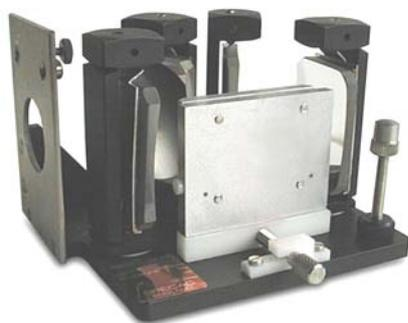
Ce système ATR, module multi réflexions à angle variable est idéal pour la détection de bandes peu intenses. Le choix de l'angle se fait par simple translation du porte échantillon et l'analyse peut être faite sur des échantillons liquides, pâteux ou solides.
