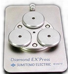
Sur cette cellule, la répartition de la force appliquée, toujours manuelle, se fait à l'aide de trois écrous situés à 120° l'un de l'autre. Cela permet de répartir uniformément la force sur toute la surface d'échantillonnage et d'obtenir ainsi une épaisseur régulière de l'échantillon.
