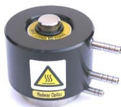
Ces jaquettes, fournies avec le moule correspondant au diamètre souhaité, permettent de thermostatier (froid ou chaud) un échantillon lors d'une opération de pressage.
