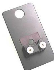
Ce support, utilisable également pour les pastilles ou fenêtres de 13mm de diamètre, est conçu plus particulièrement pour les rondelles servant à la réalisation de pastilles de 1, 3 et 7mm (Mini presse de table).
