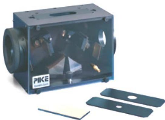
La conception optique de cet accessoire de réflexion spéculaire permet d'obtenir un faisceau collimaté au niveau de l'échantillon.
