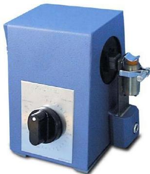
Le Specamill permet le broyage et le mélange uniforme des échantillons en fines particules. Le broyage est réalisé par la vibration rapide de trois billes dans une capsule de 3 ml de capacité.
