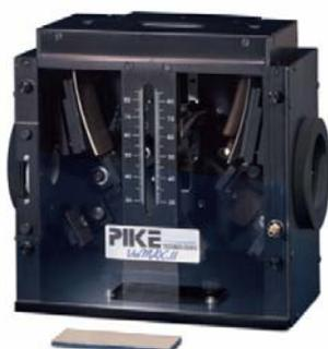
La conception optique du VeeMaxII lui permet un alignement permanent quelque soit l'angle d'incidence souhaité.
