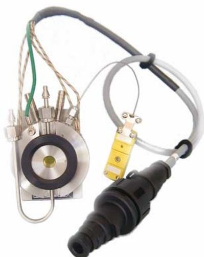
La série 'DLC' est également disponible en version thermostatable/chauffante. Un canal permet de faire circuler le fluide thermostatable désiré et un système chauffant permet de contrôler la température. On peut ainsi travailler dans la gamme dynamique allant de -80°C à +240°C (joint Kalrez).
