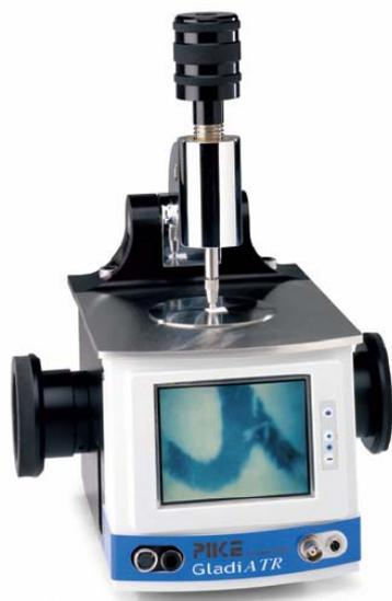
Ce système a la particularité de pouvoir être équipé d'un système d'imagerie intégré (grossissement par 110, écran LCD) qui permet de positionner idéalement et de visualiser la zone échantillon mesurée.
