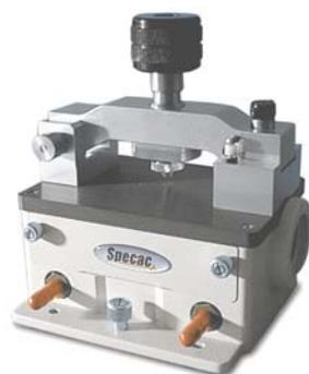
Le Silver Gate ATR simple réflexion est un système à haute énergie (environ 45%) conçu pour l'analyse d'échantillons, ce, avec très peu de préparation.
