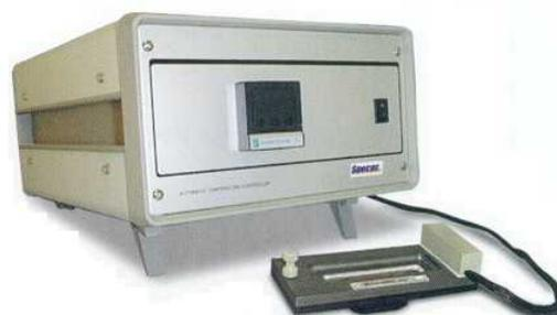
Platine, mode statique, chauffante électrique 200°C
