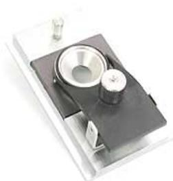
Ce support universel 3''x2'' peut être utilisé pour des échantillons type film ou pastille de taille allant de 13mm jusqu'à 40mm en diamètre et jusqu'à 13mm en épaisseur. La pièce centrale étant amovible, l'ouverture peut ainsi être de 10mm ou 22mm.
