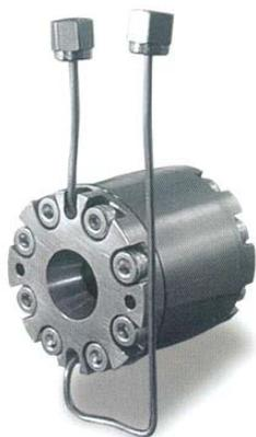
Fournie avec certificat, cette cellule est conçue pour une utilisation en pression allant jusqu'à 5000psi. Les matériaux utilisés de façon standard sont le ZnSe, le spectrosil B et le Saphir pour les fenêtres et l'acier 316L pour le corps de cuve. Cependant, d'autres matériaux sont disponibles sur demande.
