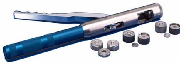
Cette presse tubulaire permet de réaliser des pastilles de faible diamètre et convient particulièrement à des applications ponctuelles ne nécessitant pas d'investir dans un système hydraulique plus conséquent
