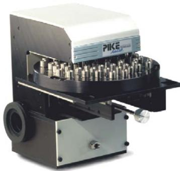
Ce système automatisé de mesure en réflexion diffuse a été développé pour répondre à des séries d'analyses de grande importance. Pouvant contenir jusqu'à 60 échantillons et une référence (position centrale, KBr pur), il est piloté via le logiciel 'AutoPro', facile d'emploi et convivial
