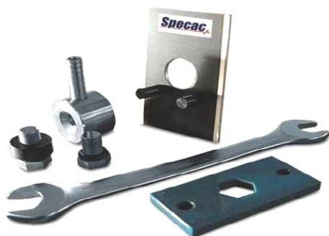
Ce moule avec prise de vide produit des pastilles de Ø 8,5mm entre deux boulons dont les extrémités ont été hautement polies. La pastille reste dans le corps du moule que l'on pose sur un support à glissière.
