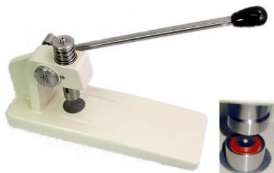
Cette petite presse de table efficace vient en complément dans les laboratoires qui réalisent régulièrement des pastilles KBr. L'abaissement en douceur du levier permet de réaliser les pastilles sans effort avec une seule main et avec un minimum de force
