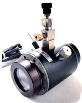
Les cuves à gaz chauffantes de 10 cm permettent l'analyse d'échantillons gazeux d'origine diverse (gaz, solide, liquide.....) de l'ambiante jusqu'à 250°C environ selon le modèle.
